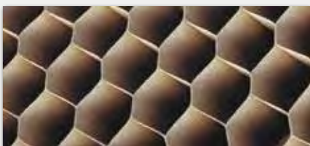
(A) Wkład stabilizujący „plaster miodu”
