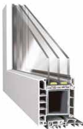
Decco - Profil PCV „Szeroki” System drzwiowy o szerokości zabudowy 125 mm wzmocniony stalą zamkniętą o grubości od 2 mm
